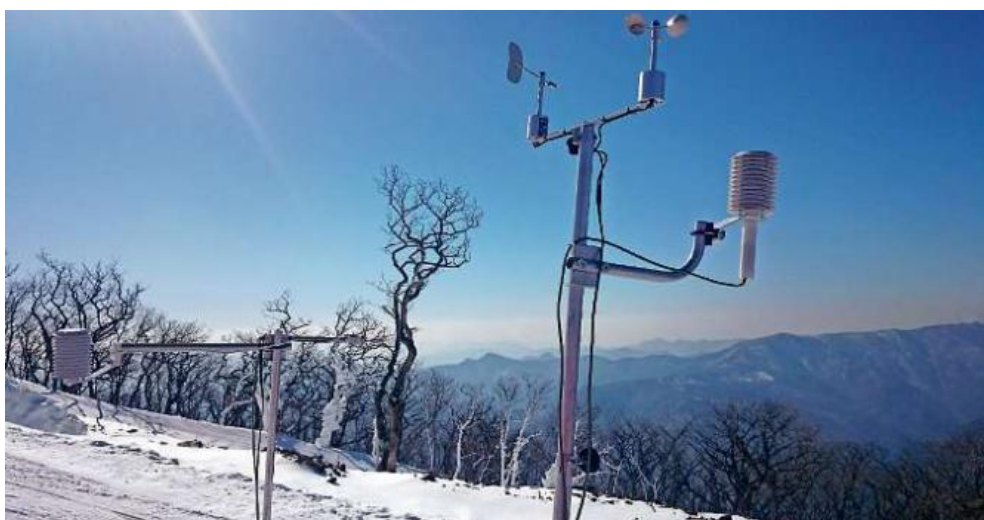
Die mobile Messstation misst am Pistenrand in Pyeongchang Luft- und Schneetemperatur sowie Wind- und Strahlungswerte. Pressebild
