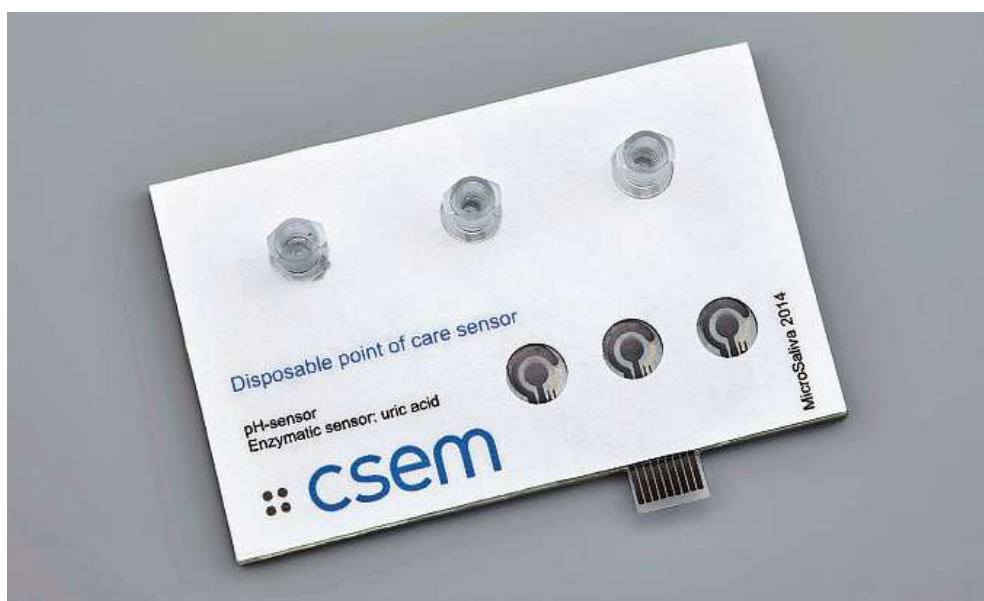
Prototyp mit Sensoren für die Speichelüberwachung zu Hause.
